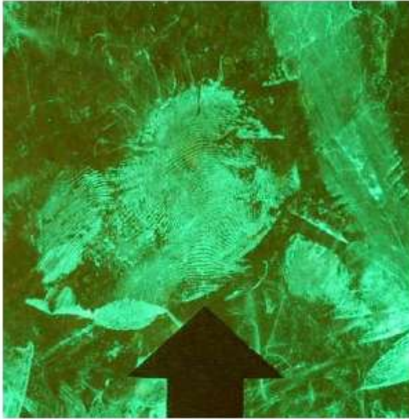
İz basic yellow 40 kullanılarak görünür hale getirilmiş (Tip 6)
