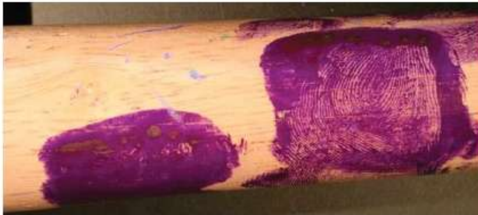
Tahta üzerindeki parmak izi Acidviolet 17 ile ortaya çıkarıldı
