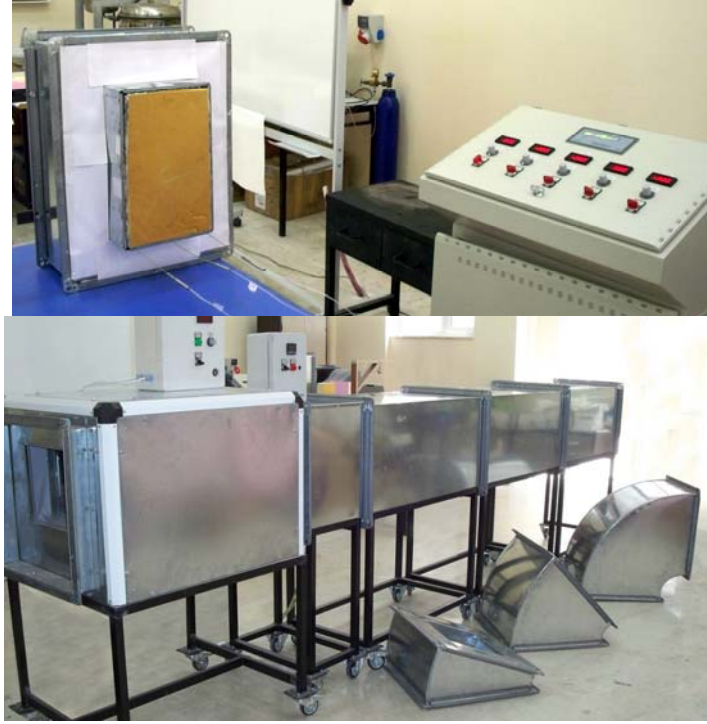
Şekil I.98. Isı Transferi Test Ünitesi ve Bilgi Toplama Sistemi
