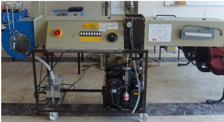
Şekil I.67. Hava Şartlandırma Laboratuvar Ünitesi
