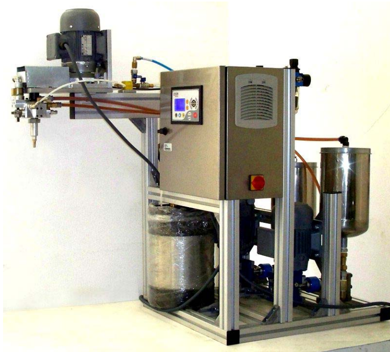
Şekil I.22. Poliüretan enjeksiyon makinası
