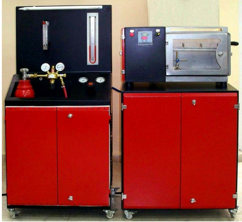
Şekil I.102. MVSS 302 Yanma Test Ünitesi
