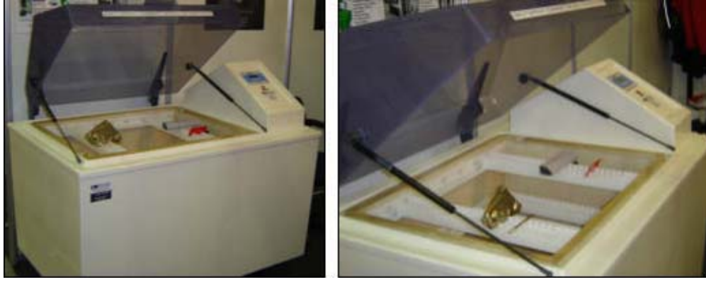
Şekil I.44. Korozyon Test Kabini, CW Equipment
