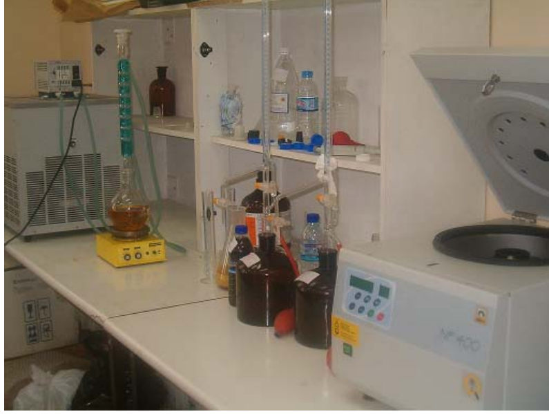
Şekil I.97. Küçük ölçekte biyodizel üretimi için düzenek (Su soğutucusu, üç boğazlı balon, geri soğutucu, manyetik karıştırıcı ısıtıcı, serbest yağ asitliği ölçümü için hazırlanan çözeltiler ve santrifüj)
