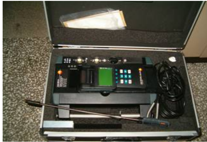
Şekil I.92. Testo 350 M/XL gaz analizörü
