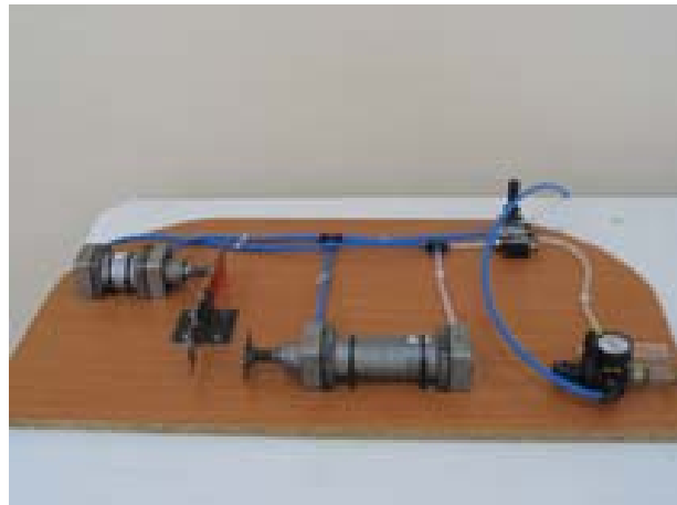
Şekil I.85. Pnömatik Kontrol Ünitesi
