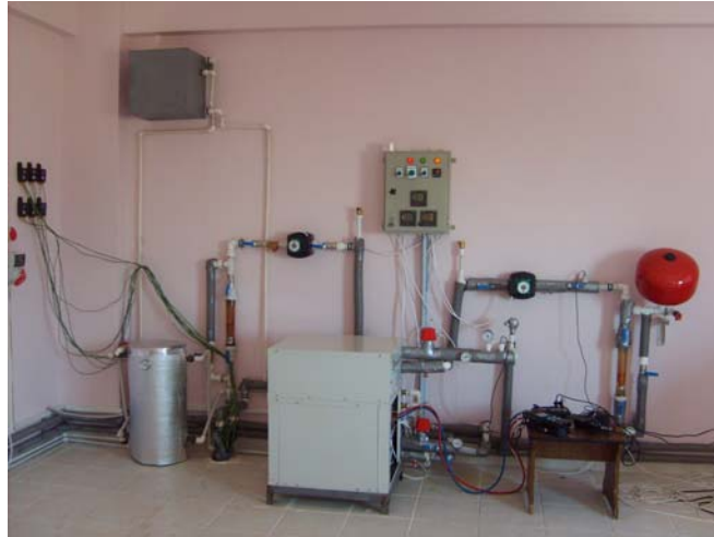
Şekil I.71. Toprak kaynaklı ısı pompası sistemi
