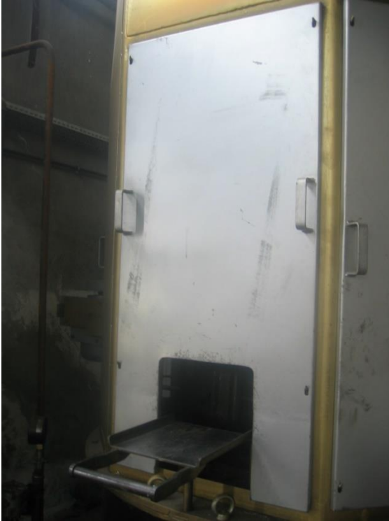
Şekil 10. Pratik olarak sökülüp takılabilen kapak
