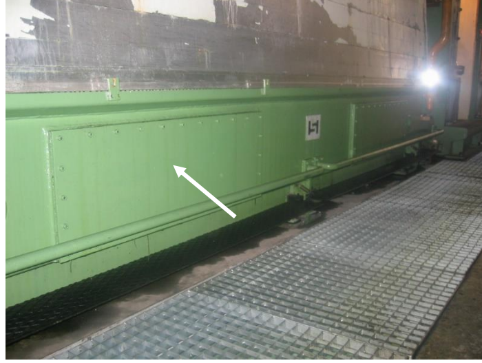
Şekil 7. Gereksiz sayıda bağlantı elemanı kullanımı
