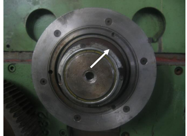
Şekil 8. Sökülmesi için özel takım gerektiren bağlantı elemanı seçimi
