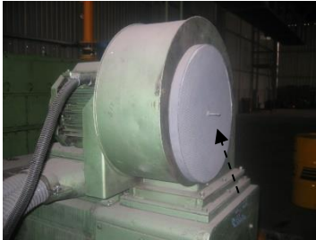
Şekil 9. Cıvatalı ve cıvatasız bağlanmış filtreler
