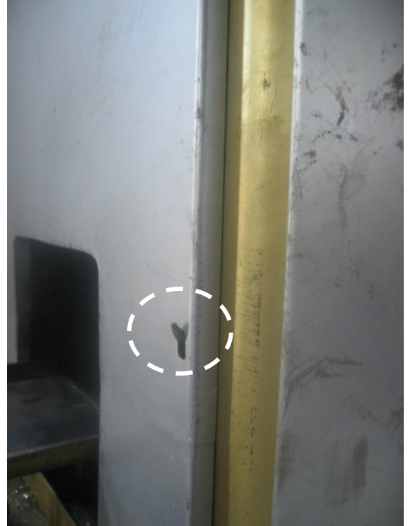
Şekil 10. Pratik olarak sökülüp takılabilen kapak
