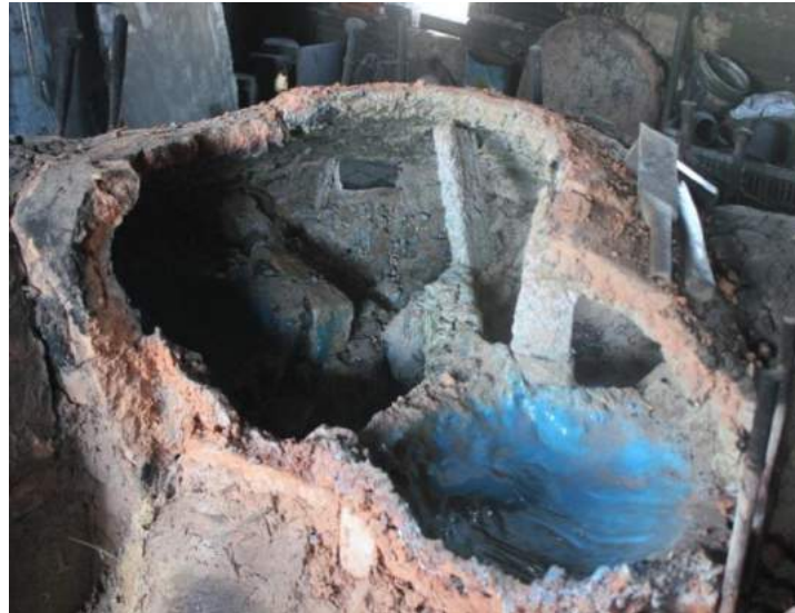
Fotoğraf 5: Geleneksel Cam Boncuk Ocağının İç Kesiti
