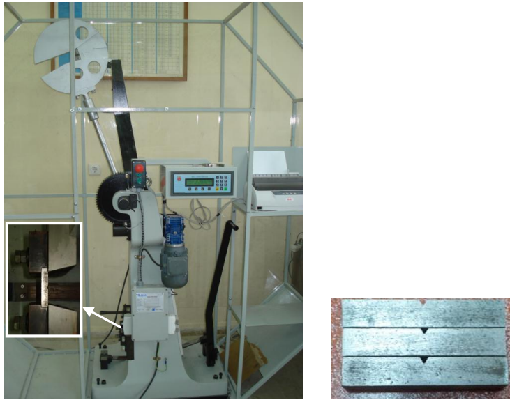
Şekil 2.2: 300 J kapasiteli bir çentik darbe deney makinesinin ve deney numunelerinin görünümü
