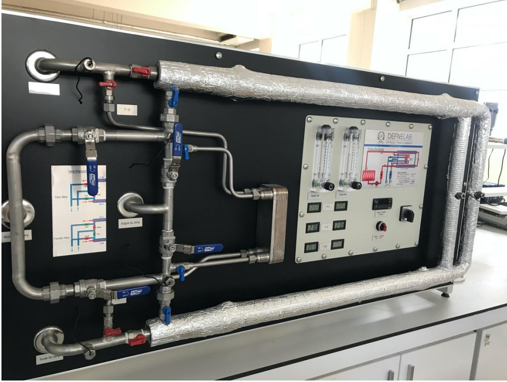
Şekil 11. Plakalı ve çift borulu ısı değıştirci düzeneđi.
