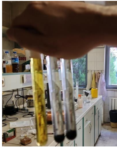
Resim 7. Elde edilen aktif kömürün iyot adsorplama deney sonucu
