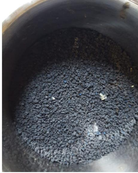
Resim 5. Pilot tesisimizde granül zeytin çekirdeğinden elde edilen aktif kömür
