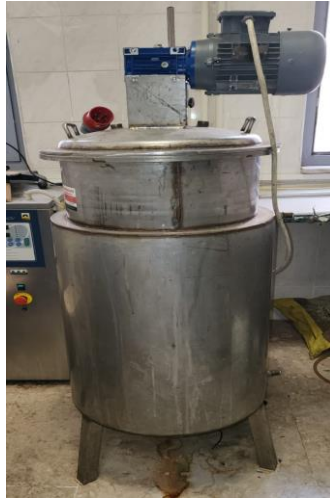
Resim 2. Deterjan üretiminde kullanılmak üzere dış paydaşlarımız tarafından temin edilen redüklü karıştırıcı kazan
