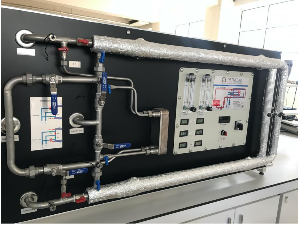
Şekil 4. Çift borulu ısı değıştirici
