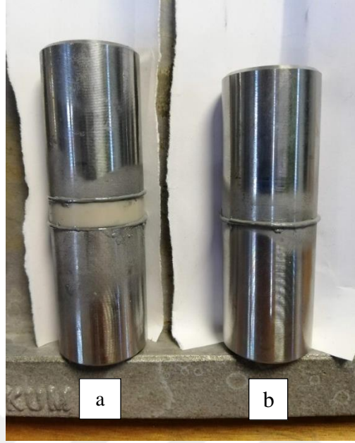
Şekil 4.24: Yapıştırıcı uygulanmış (a) çelik-PEEK-çelik, (b) çelik-çelik çekme numunesi.
