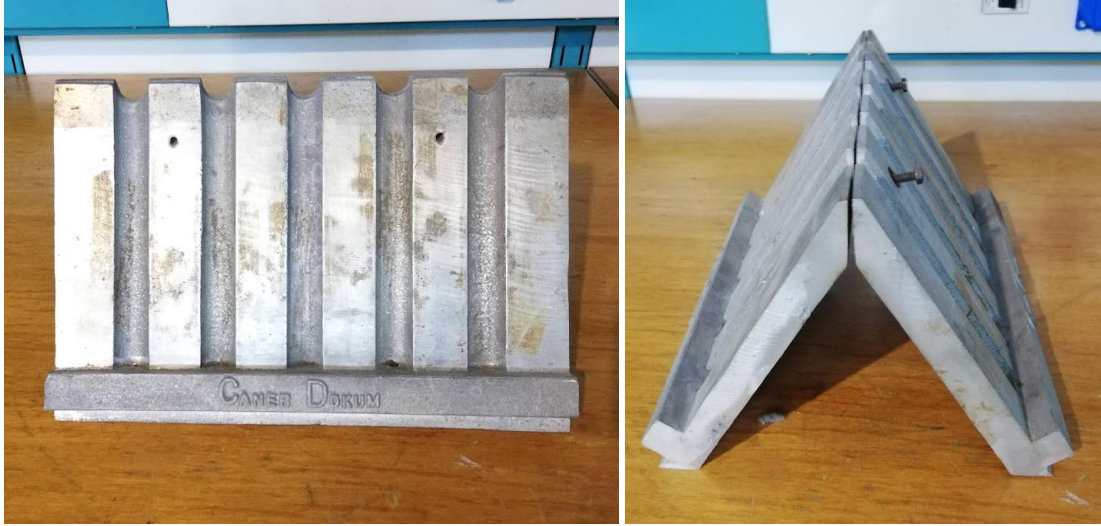
Şekil 4.22: Kurlenme sırasında yerçekimi ile numune sabitleyen aparat
