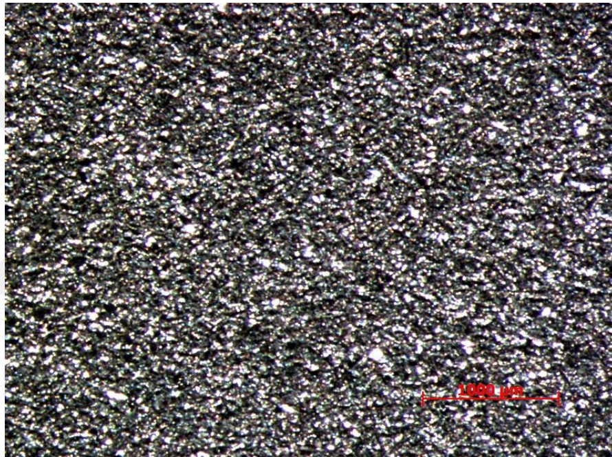
Şekil 5.9: Kaba kumlama yapılan çelik karşılıklar.
