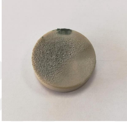
Şekil 5.3: Yakın mesafeden kaba kumlama yapılan yüzeyi bozulmuş PEEK numune.
