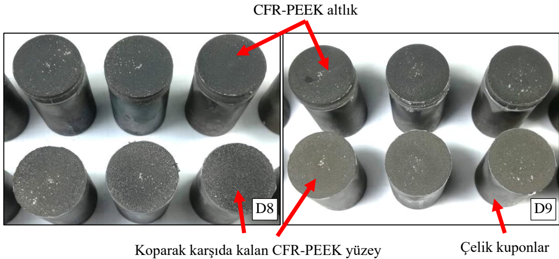
Şekil 5.46: 3. Ti kaplama grubu numunelerinin ayrılma yüzeyi görüntüleri (D8 ve D9).
