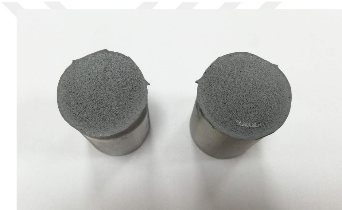
Şekil 5.11: Çelik-çelik numunelerin ayrılma yüzeyi.
