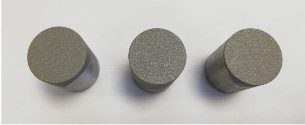
Şekil 5.9: Kaba kumlama yapılan çelik karşılıklar.
