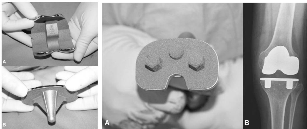
Şekil 3.9: Ti-6Al-4V üzerine inert gaz (argon) tel ark sprej yöntemiyle saf titanyum poroz kaplama (Davis 2004).
