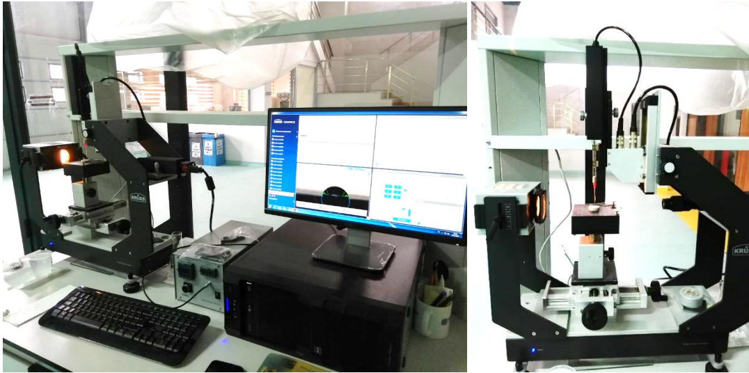
Şekil 4.11: Krüss DSA30S damla şekli analiz sistemi.
