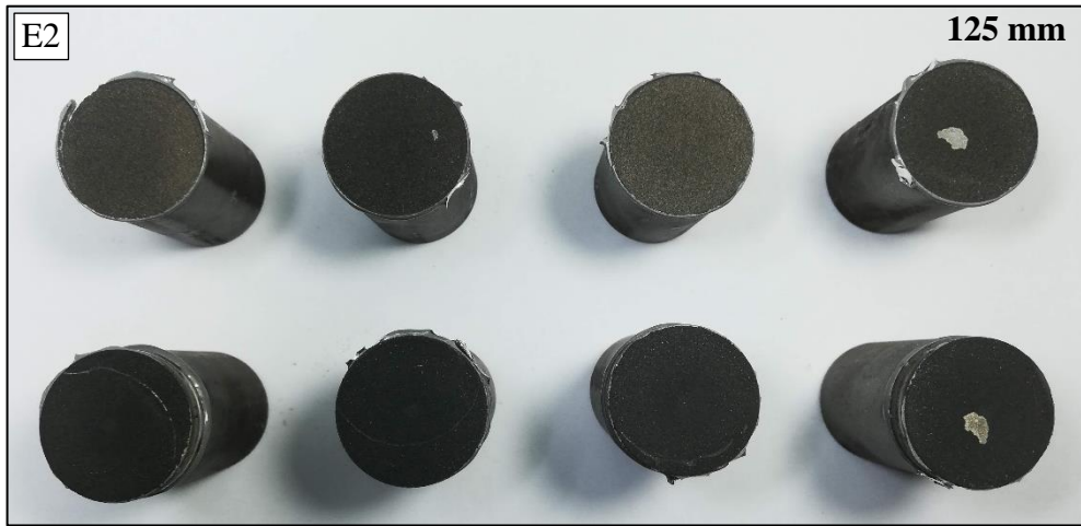
Şekil 5.54: 1. HAp kaplama deney grubundan E2 kodlu numunelerin çekme testleri sonrası kırık yüzeyleri.
