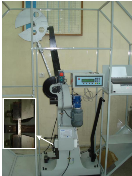
Şekil 2.2: 300 J kapasiteli bir çentik darbe deney makinesinin ve deney numunelerinin görünümü
