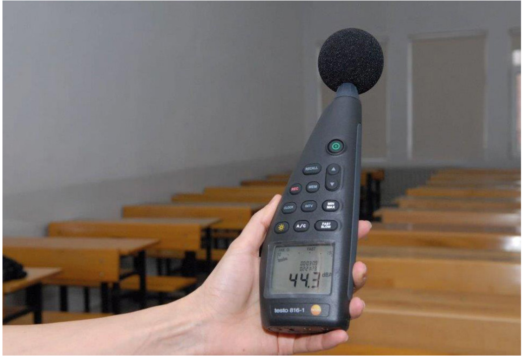
Şekil 13. Gürültü Seviyesi Ölçüm Cihazının Kullanımı
