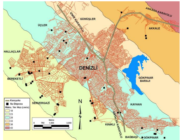
Şekil 6. Pamukkale fayı kaynaklı M_w 6.5 senaryo Depremi için PGV zonlarıyla Denizli su dağıtım şebekesinin üst üste çakıştırılması
